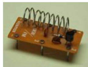
Slika 1 Primer zračne cilindrične tuljave v elektronskem vezju.
